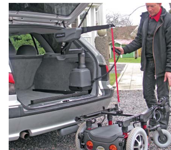
Carolift 6000 soulève et charge la structure d'un fauteuil roulant Carony Go dans une Peugeot 406 à hayon arrière très incliné.
