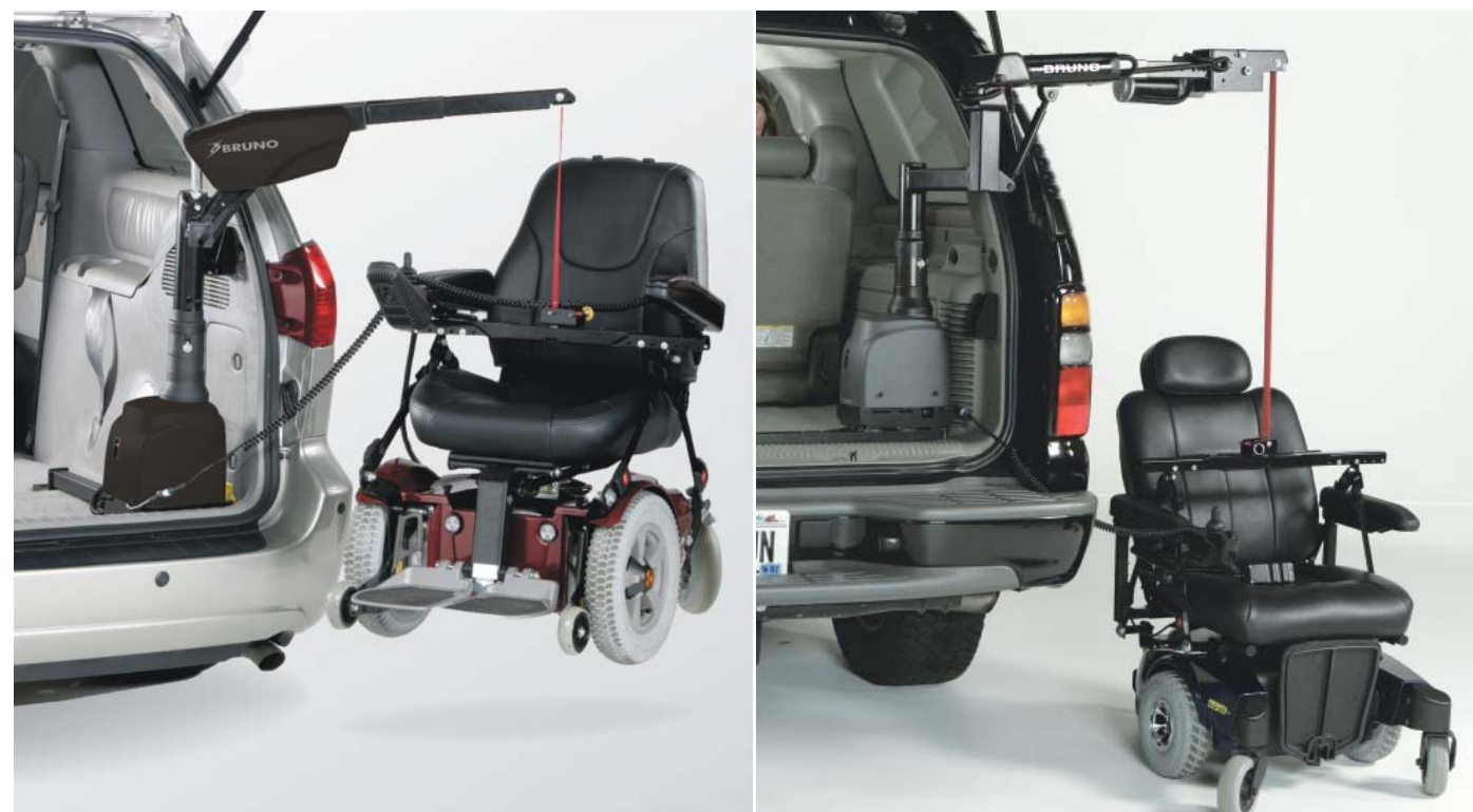
Carolift 6000 a une capacité de levage de 181 kg.
