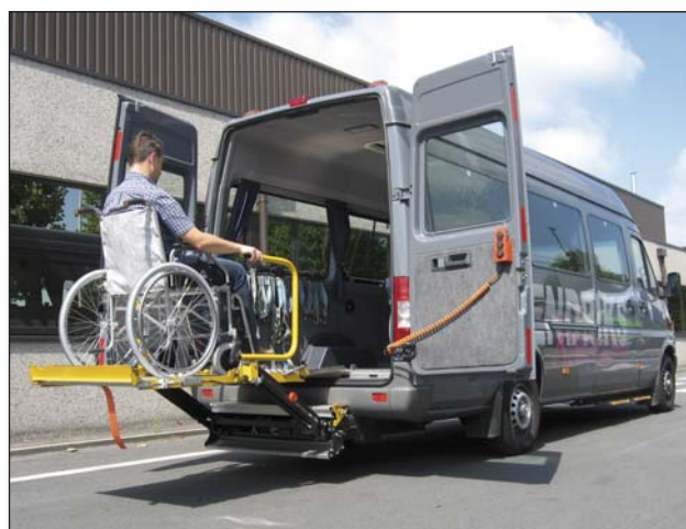
DH-CH 300 kg - Hayon rétractable avec cassette
