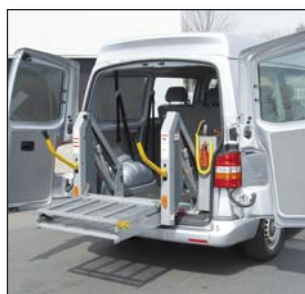
S957 Plateforme pliante pour les véhicules à hauteur de passage réduite
