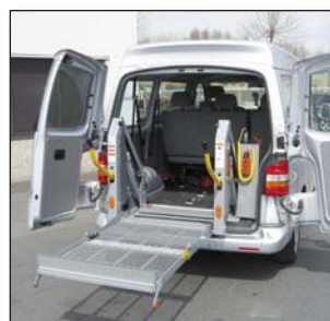
S957 Plateforme pliante pour les véhicules à hauteur de passage réduite
