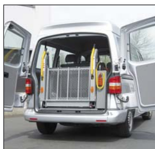
S957 Plateforme pliante pour les véhicules à hauteur de passage réduite
