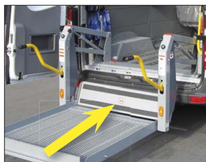
S955 Pont de liaison au plancher automatique monté sur le plateau
